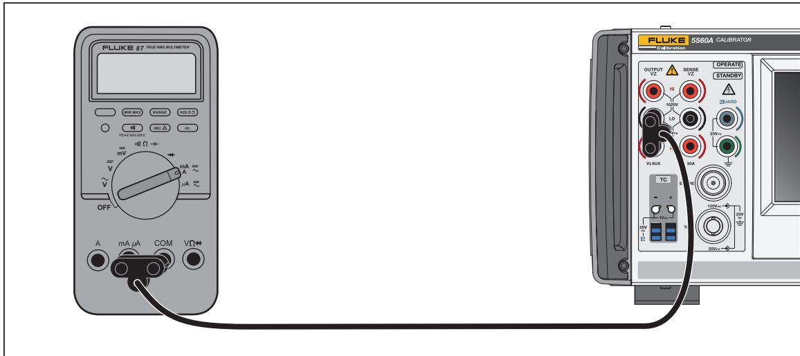
그림 7. DUT 연결 : DC 전류 / AC 전류 < 3.1A
