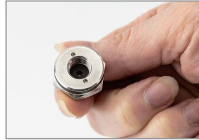
1. 밀봉 페룰이 접속부 내에 잘 맞추어졌는지 확인하세요. 0.080 - 0.100인치 직경의 프로브에는 검정색 고무 페룰을 사용하고, 0.100 - 0.125인치 직경의 프로브에는 빨간색 고무 페룰을 사용하세요.
